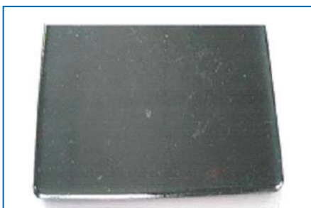
Abb. 5: Beschichtung nach Aushärtung von Polyol 014 mit PIC 1 Neue AB-Polyol 014
